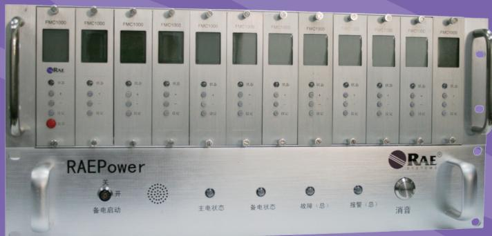
FMC-1000 是一款智能型、采用模块化设计、通道独立工作与集中控制相结合模式、标准 19" 3U 盘装结构的可燃气体报警控制器。该控制器可接收各种标准 4~20mA 模拟信号，支持 RS485 MODBUS 通讯以实现远程通讯功能，在最大程度上满足危险工业现场对安全性和可靠性要求的同时针对不同用户提供订制化的产品。该控制器还具有现场声光报警，报警记录存储、查询，可编程报警及故障开关量输出等功能，可灵活控制外部报警、排风及其它外部设备。
